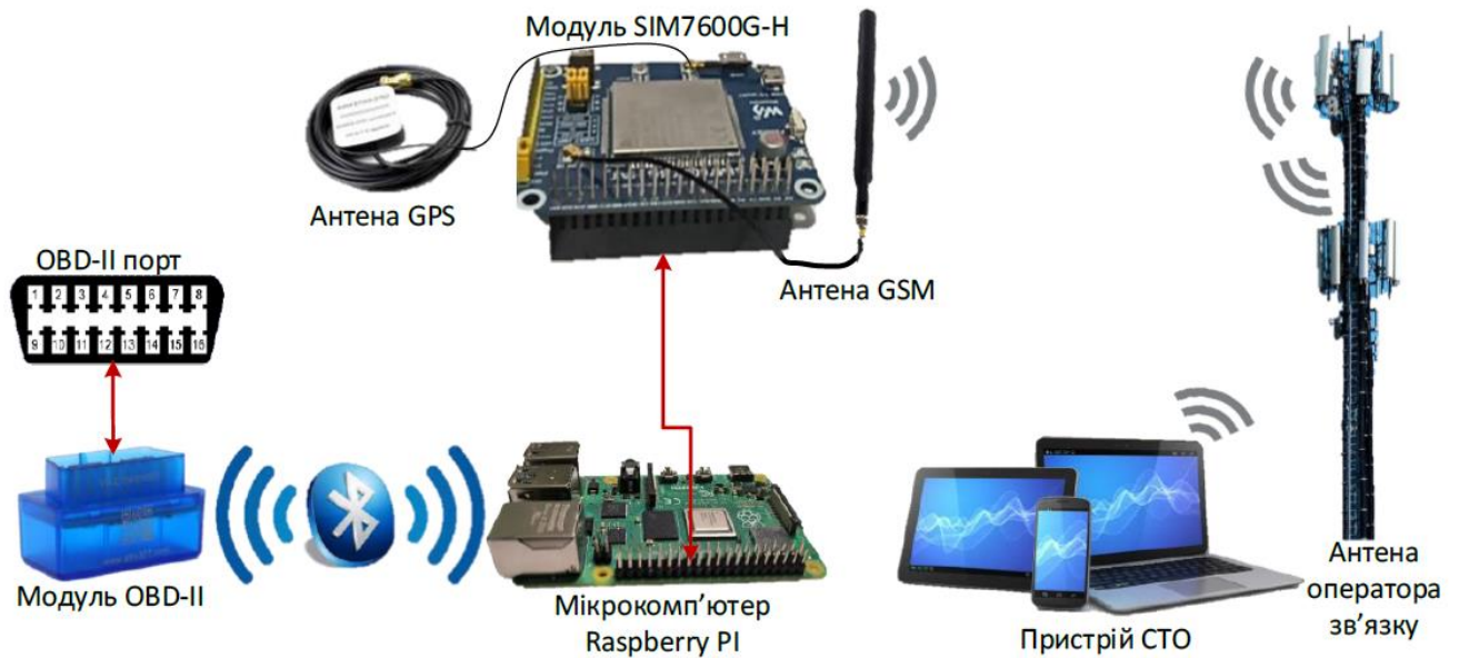
Рис. 1. Схема роботи пристрою віддаленої діагностики автомобіля.
