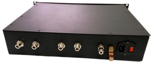
Рис. 3. Зовнішній вигляд модемного пристрою (з права на ліво: роз'єм типу WTY0122 з кнопкою «Живлення 220В», DN 3 - управління, N типу - сигнал ПЧ RX1, N типу - сигнал ПЧ TX1, N типу - сигнал ПЧ RX2, N типу - сигнал ПЧ TX2)
