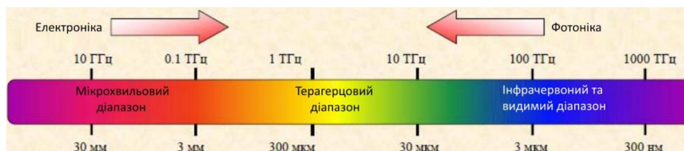
Рис.1. «Місце» терагерцового діапазону в електромагнітному спектрі.
