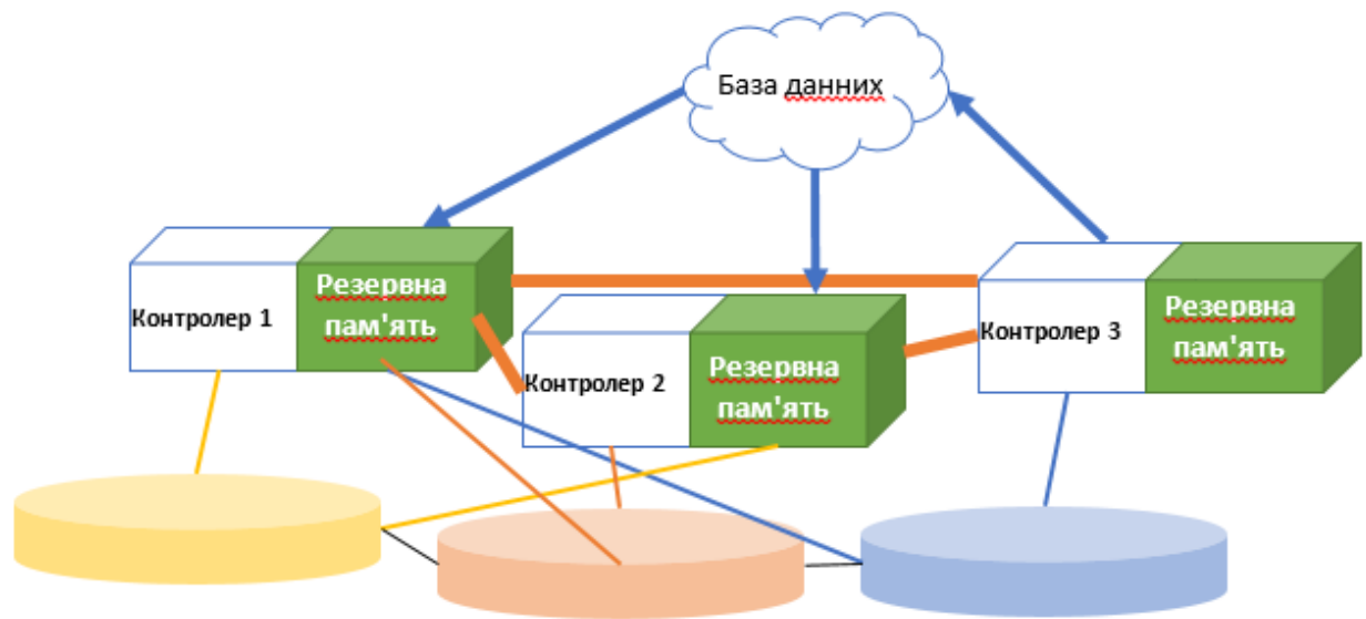
Рис. 5. Архітектура мережі SDN з резервуванням конфігурації контролерів за допомогою спільної бази даних.
