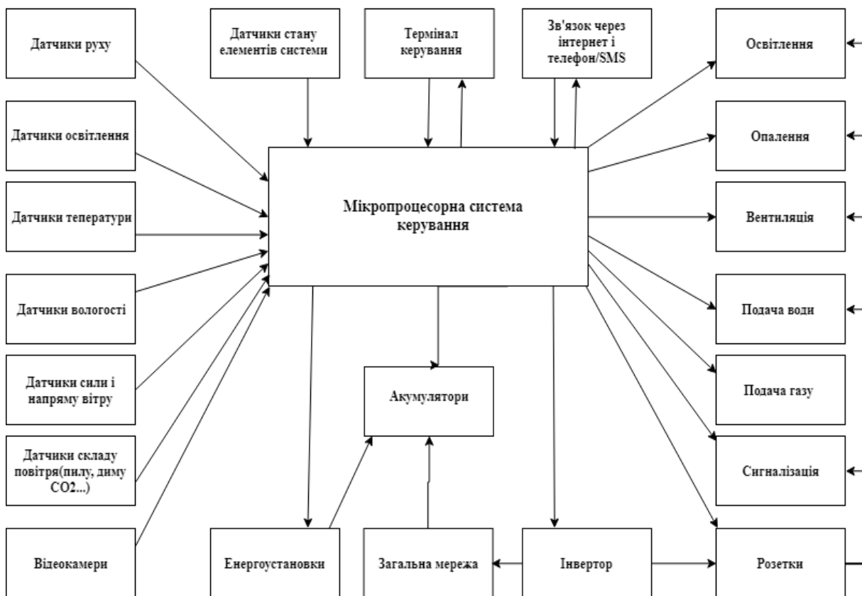
Рис. 1. Спрощена схема microgrid в поєднанні з розумним будинком.
